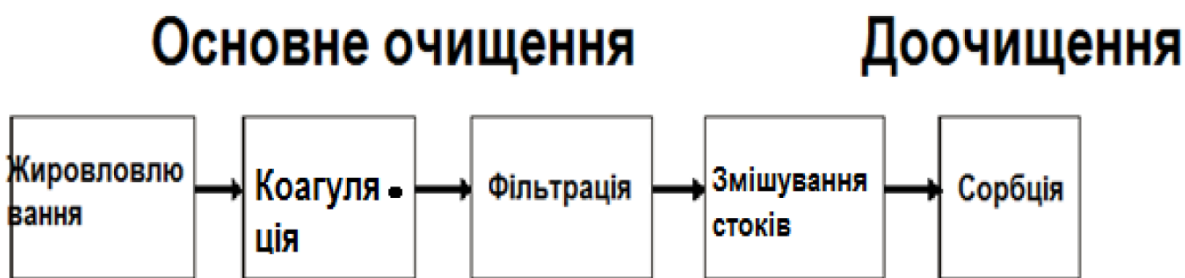
Рис.1. Схема очищення стічних вод технологічних ліній виробництва кисломолочного сиру та вершкового масла
