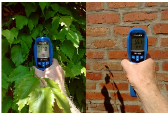
Рисунок 1 – Загальний вигляд пірометра FLUS IR-820 та процес його використання
