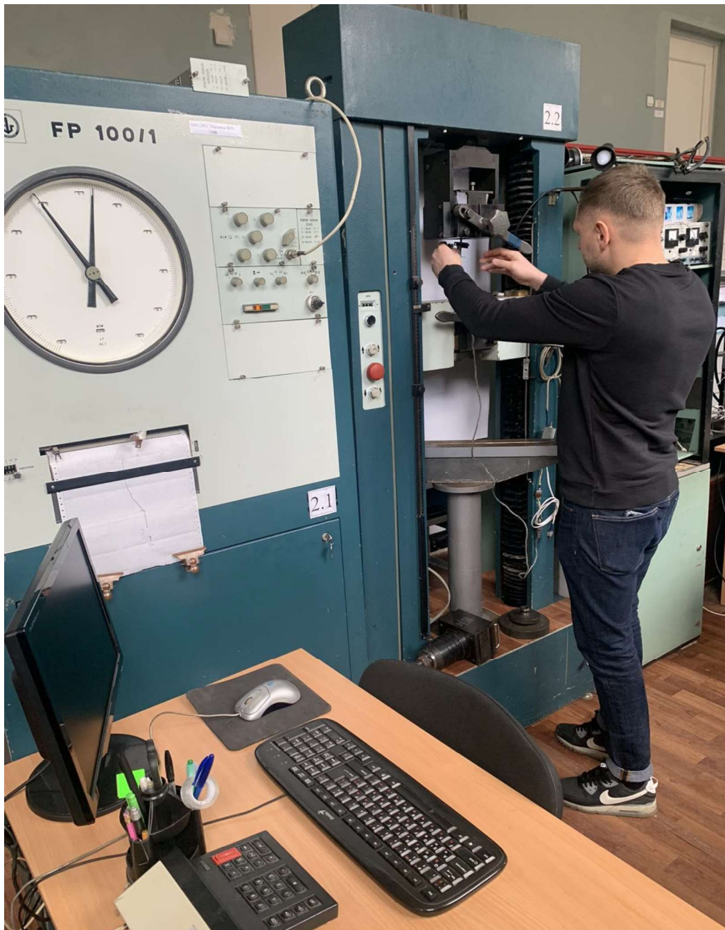
Рис.1. Проведення експериментальних досліджень на втомну міцність
