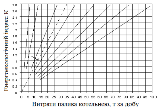
Рис.1. Сімейство графіків відповідності енергоекологічного індексу K витратам палива для котелень різної потужності від 400 кВт до 50 МВт (пунктирна лінія відповідає потужності котельні 10 МВт).
