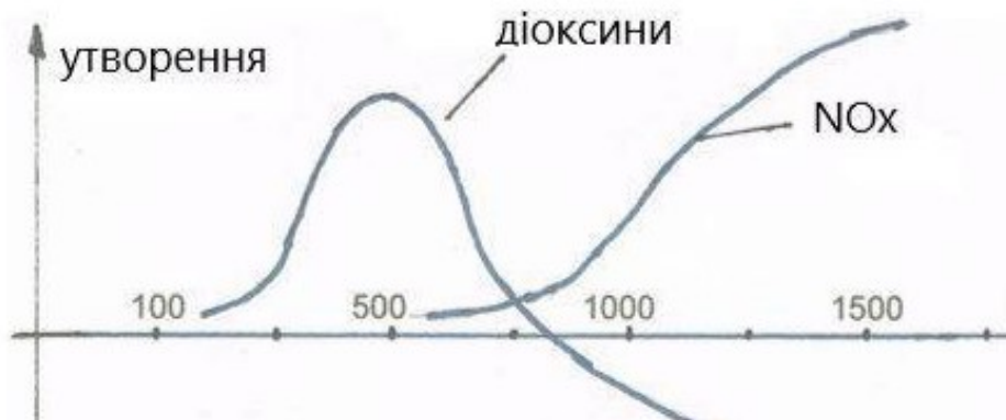
Рисунок 5 - Утворення діоксинів і NO x в залежності від температури
