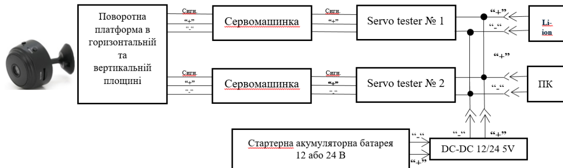
Рисунок 1 – Схема пристрою для здійснення спостереження за противником
