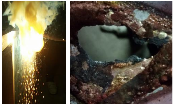
Рис 2. Процес та результат проплавлення металу
