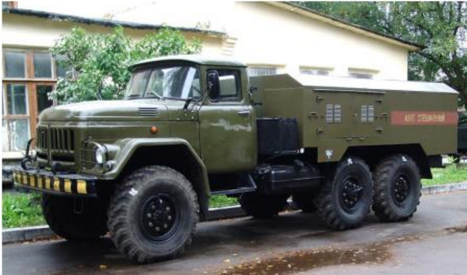
Рисунок 1 – Уніфікована газозарядна станція УГЗС.М-131
