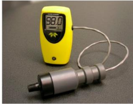
Рисунок 3 – Портативний аналізатор азоту “AN-300”
