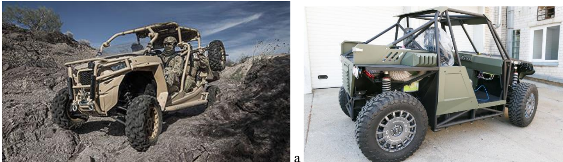
Рис.1. Військове багі Polaris MZPR (у 4-місній модифікації) армії США[5] а) та Krampus [6] б)
