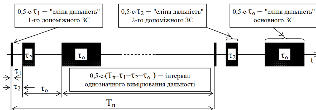
Рисунок 6.11 – Використання складених зондувальних сигналів для усунення ефекту "сліпих дальностей"
