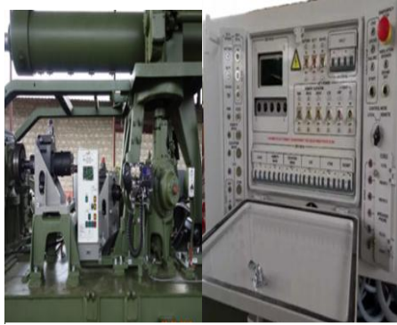
Рис.7. Механізм вертикального наведення та апаратура старту автоматика ПУ 5П73MRz.
