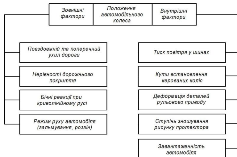
Рисунок 2. Фактори що впливають на динамічні кути встановлення керованих коліс під час руху транспортного засобу.
