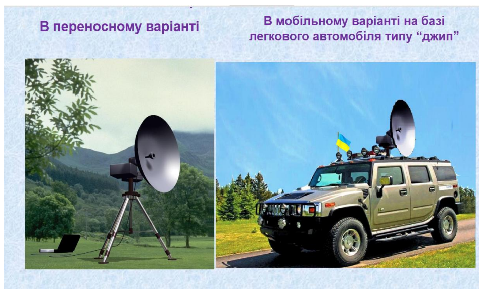
Рисунок 2. Малогабаритна тропосферна радіорелейна станція нового покоління.
