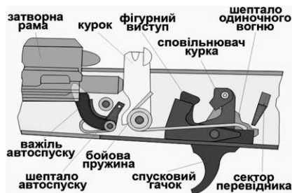
Рисунок 1 - Ударно-спусковий механізм автомата Калашникова
